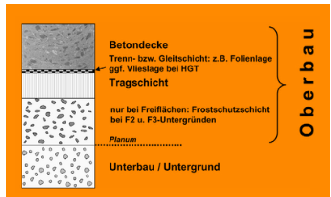
Bild 2: Aufbau eines Betonbodens
